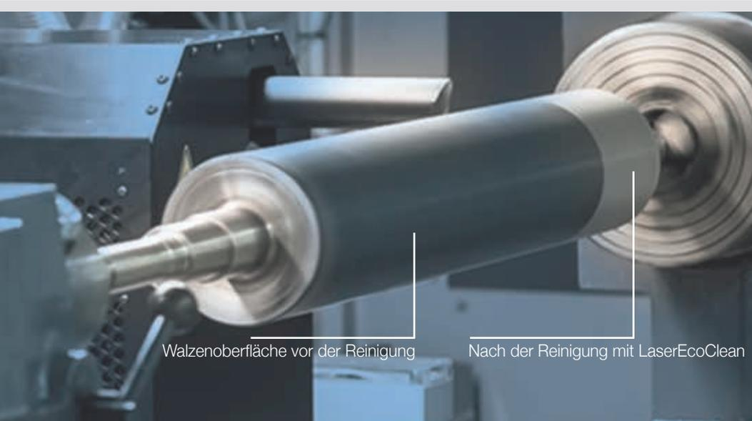
Während der Nutzung Ihrer Rasterwalzen können sich die Näpfchen mit Farbrückständen zusetzen, wodurch sich das Volumen der Näpfchen verringert. Nach der Laserreinigung mit der LaserEcoClean-Technologie kann das Schöpfvolumen Ihrer Rasterwalzen wieder optimal ausgenutzt werden und Sie profitieren wieder von einer gleichmäßigen Farbgebung im Druckprozess.
